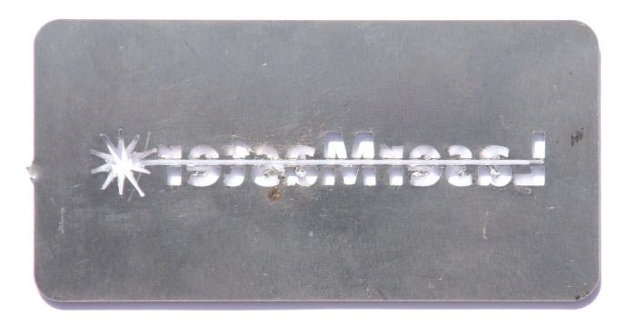
NO FINISH - BACK SPLATTER ON UNDERSIDE FROM BED SLATS
